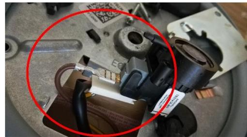
Le montage est terminé, n'oubliez pas de rebrancher le tube pneumatique relié au bouton poussoir sur la petite tétine de l'interrupteur intégré.
